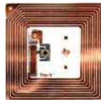
Chip i mitten och antenn runtom.
