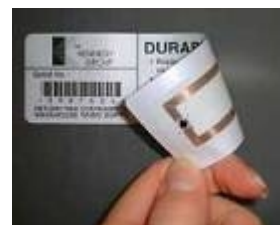
Etikett med både streckkod och Rfid-märkning.
